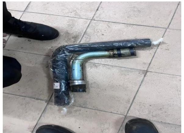
發電機組冷卻管路訂製品對照
