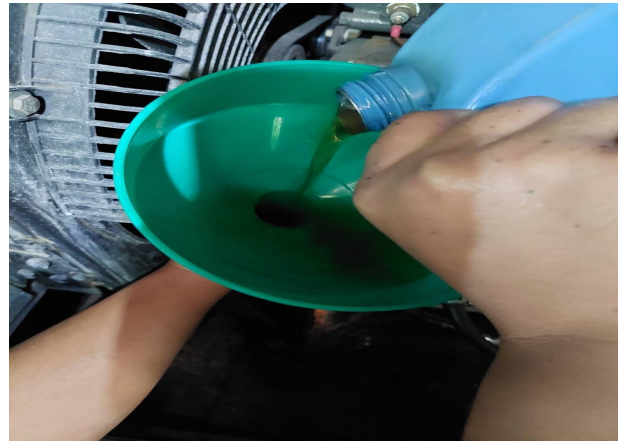
引擎機油添加施工
