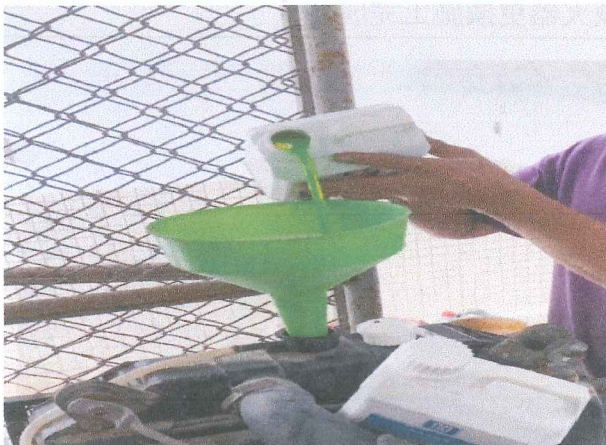
冷卻水箱精添加施工
