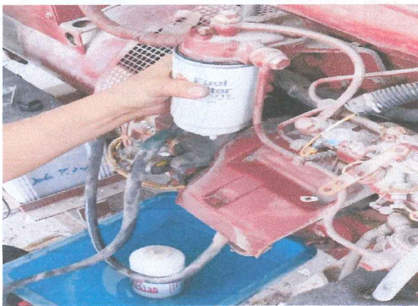
柴油濾清器更換施工
